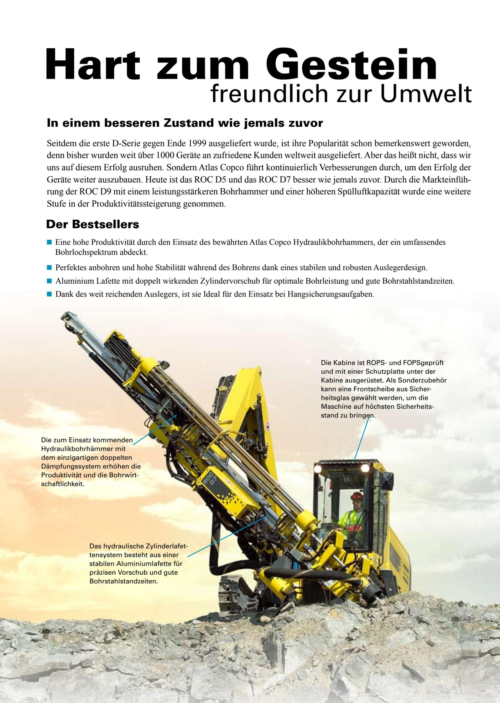
Die zum Einsatz kommenden Hydraulikbohrhämmer mit dem einzigartigen doppelten Dämpfungssystem erhöhen die Produktivität und die Bohrwirtschaftlichkeit.
